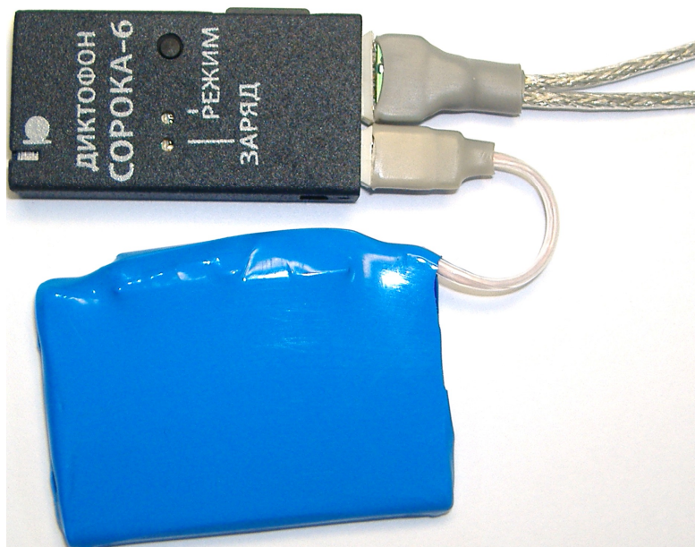
Рис. 7. Пример работы диктофона «СОРОКА-06» с внешним аккумулятором и внешними стерео микрофонами.
