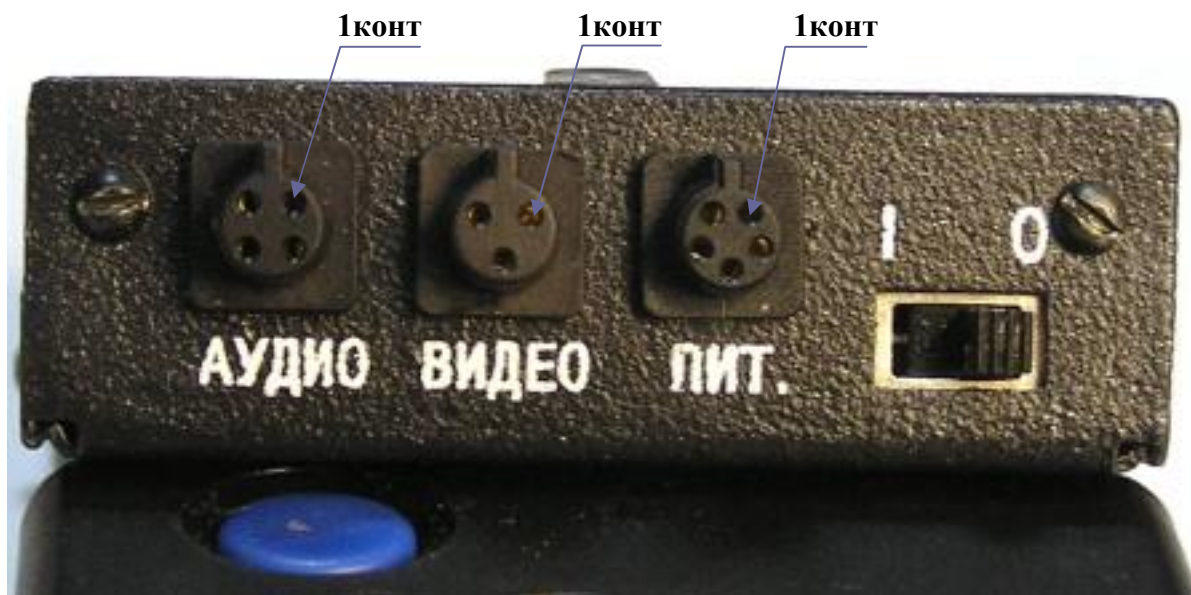
Рисунок А.1. Назначение разъемов. Нумерация контактов по часовой стрелке.
